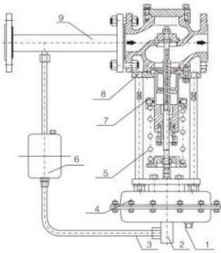
单座自力式压力调节阀(控制阀前)
